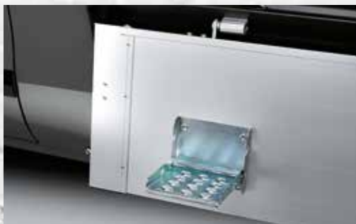
NEDFELLBARE STEG INTEGRERT PÅ INNSIDEN AV SIDELEMMENE
